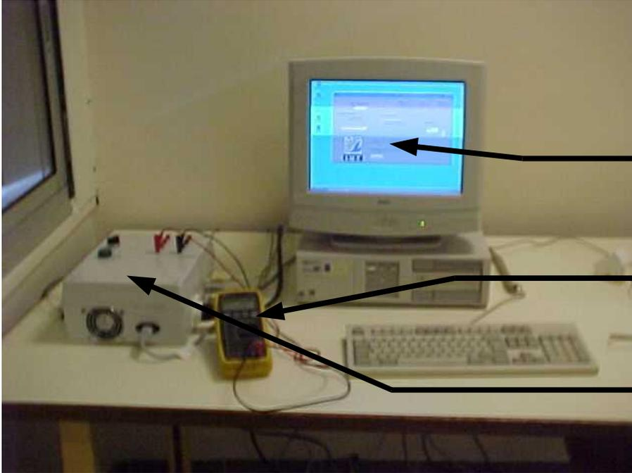
Un ordinateur et un logiciel pour commander le déplacement en translation de la lampe et du pyranomètre et le déplacement en rotation des filtres
